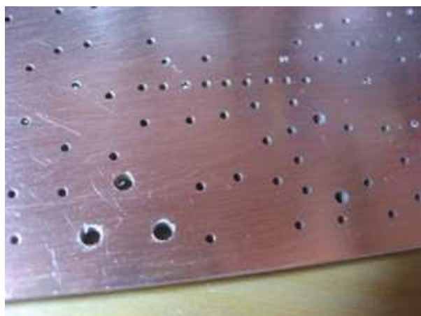
Les trous sont bien visibles et assurent un repérage précis pour le positionnement des futures pistes à dessiner
