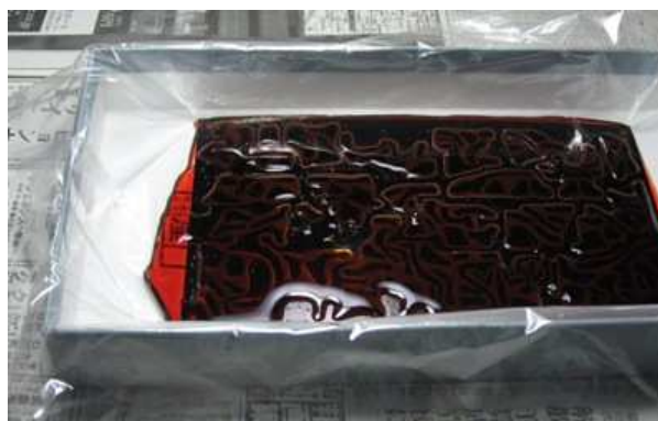
Le circuit cuivré est plongé dans un bain de perchlorure
