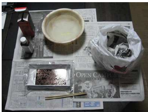
Bac pour tirage, Bac pour rinçage, et perchlorure de fer
