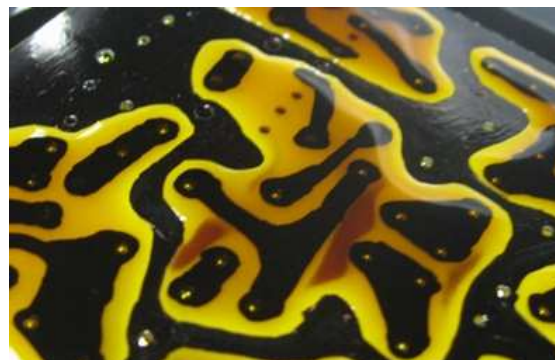
Une grande partie du cuivre a disparue, restent quelques îlots
