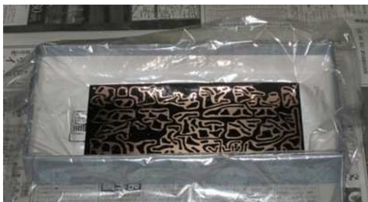
Le circuit est complètement décapé de son cuivre
