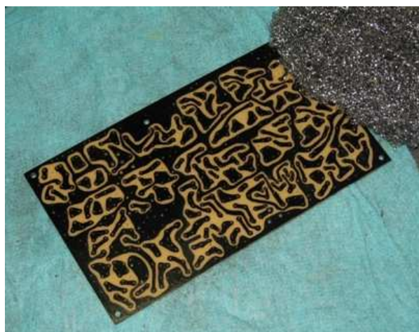
Décapage au tampon abrasif de l'encre noire sèche
